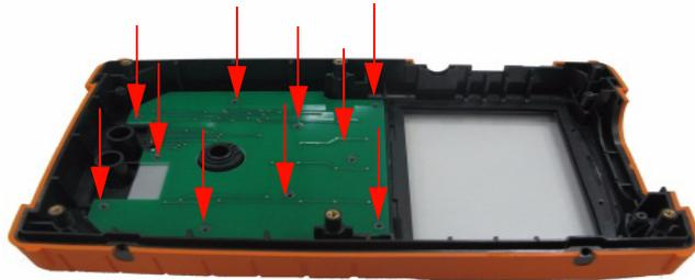
**Figura 8-11** Extraiga los diez tornillos de la cubierta frontal
