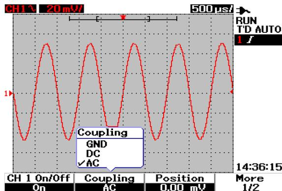
Figura 3-6 Acoplamiento de canal de CA
