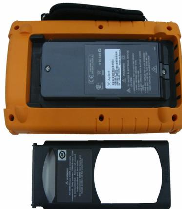
**Figura 8-2** Extraiga la base del instrumento
