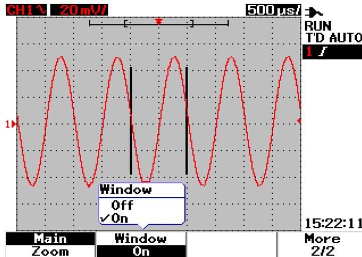
**Figura 3-16** Cuando se activa la función Window aparece una barra de selección del área de zoom en el centro de la pantalla. Ajuste el control giratorio hacia la derecha para ampliar el área del zoom.
