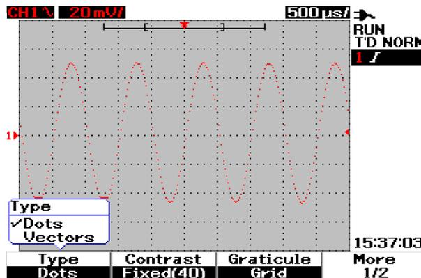
Figura 3-22 Tipo de visualización de puntos
