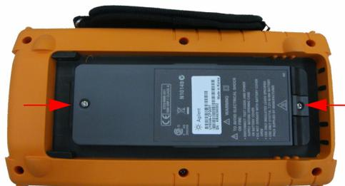
**Figura 8-3** Extraiga los tornillos de la cubierta de la batería
