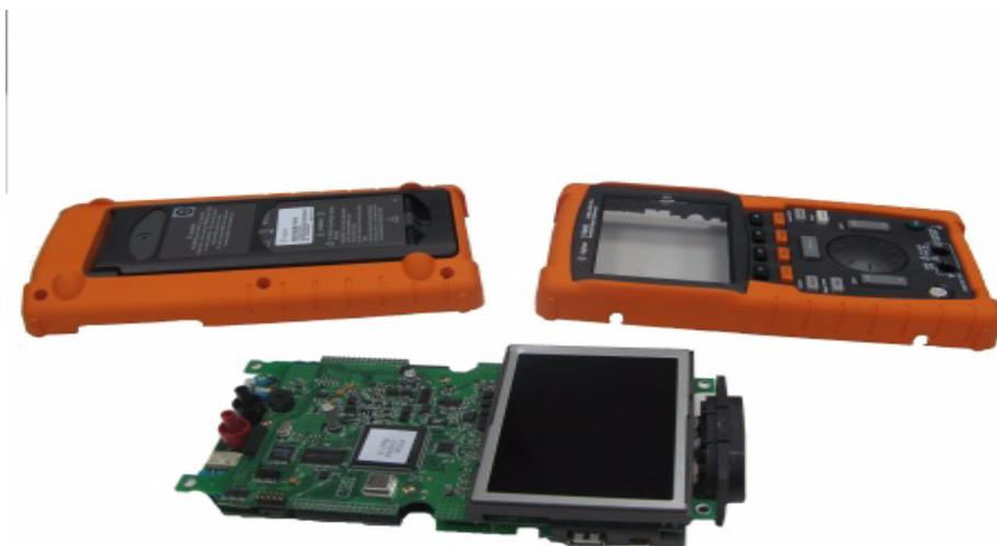
**Figura 8-10** Extraiga la carcasa frontal (derecha) y la posterior (izquierda) de la PCBA del instrumento
