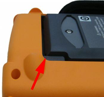
**Figura 8-1** Empuje en la dirección de la flecha para retirar la base
