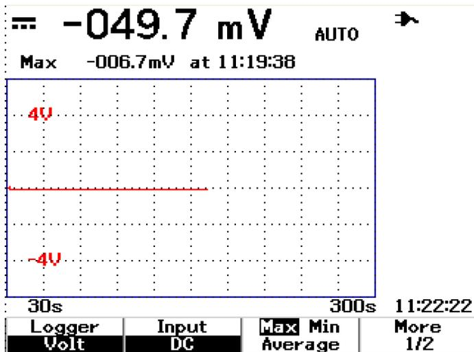
**Figura 5-2** Una vez superados los 150 segundos, el gráfico se comprime automáticamente a la mitad de la pantalla y la base de tiempo pasa a ser 30 segundos — 300 segundos.
