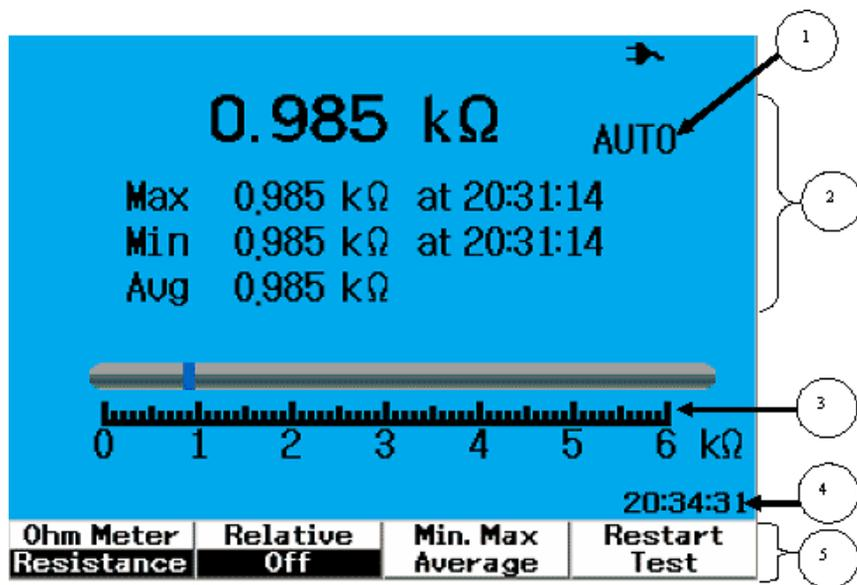
Figura 2-3 Interpretación de la pantalla del multímetro
