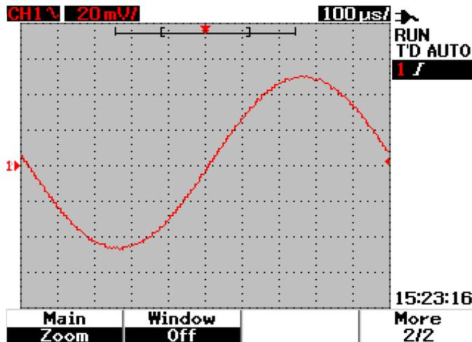
Figura 3-17 Presione F1 para activar la función de acercamiento
