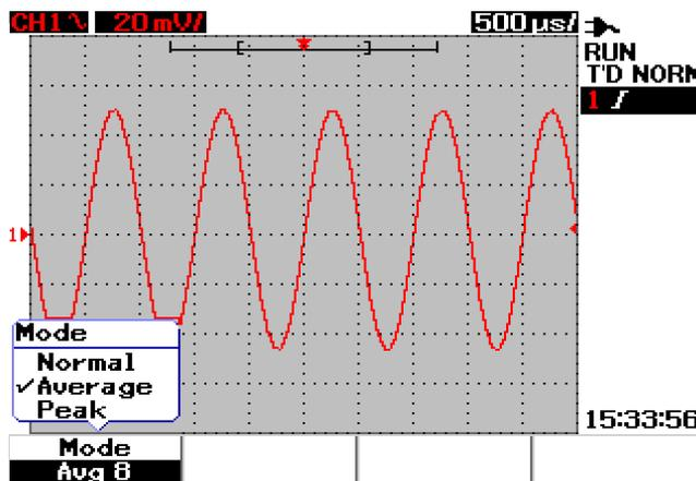
Figura 3-20 Modo de adquisición Average
