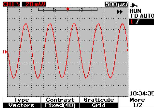
Figura 1-9 Ajuste del contraste de la pantalla
