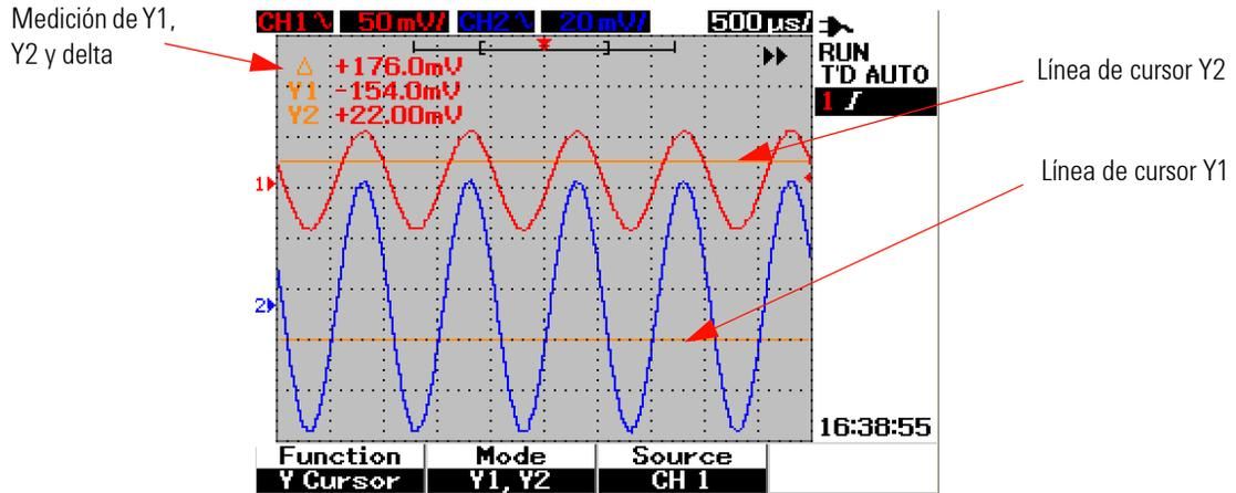
**Figura 3-34** Medición del cursor Y para la señal del canal 1 con líneas de cursor Y1 e Y2
