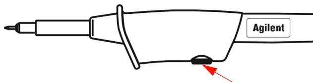
**Figura 1-12** Condensador de ajuste para compensaciones de sondas
