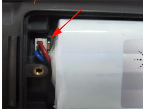
**Figura 8-4** Extraiga el conector de tres cables de la placa PCBA con una pinza
