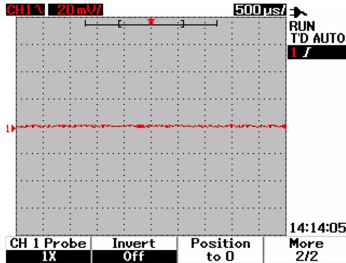
**Figura 3-4** Restablezca el símbolo de referencia vertical de tierra a cero voltios.
