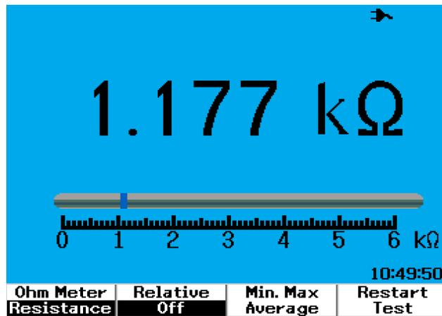
**Figura 4-3** Medición de resistencia
