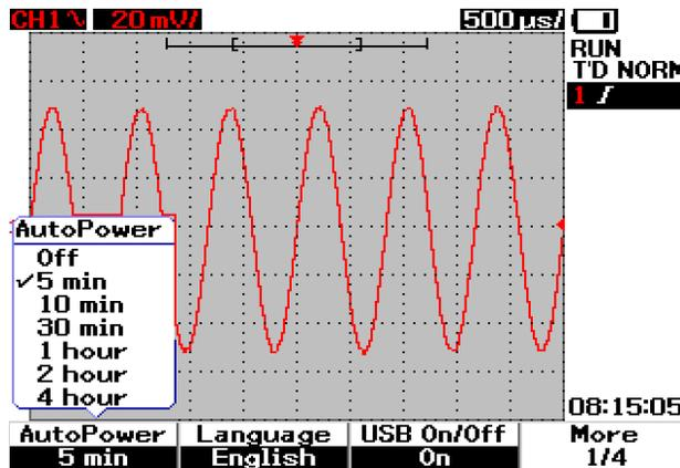
Figura 1-8 Función de apagado automático
