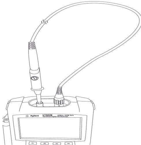
**Figura 1-10** Conexión para la compensación de sonda
