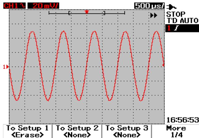
**Figura 3-44** La pantalla <None> indica que no se guarda ningún archivo de configuración. <Erase> en Setup 1 muestra que puede borrar el archivo de configuración de la memoria interna.
