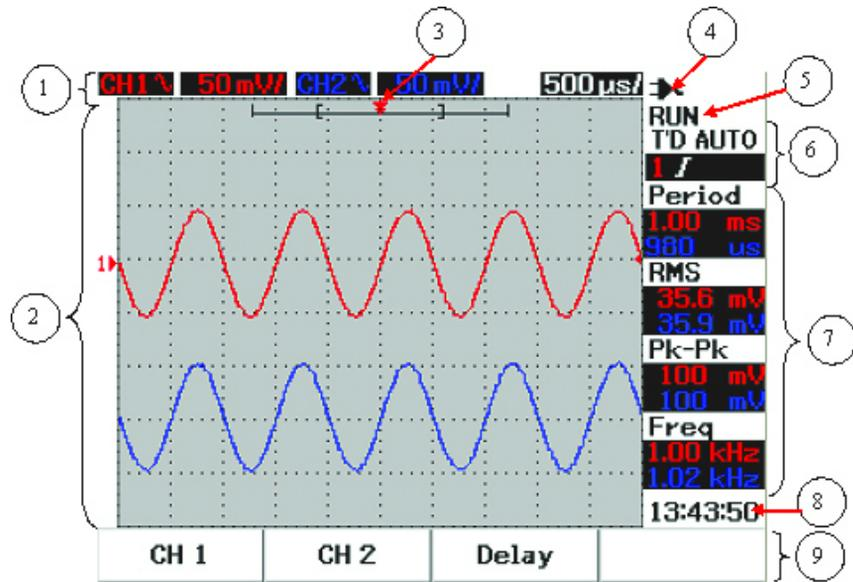
**Figura 2-2** Interpretación de la pantalla del osciloscopio
