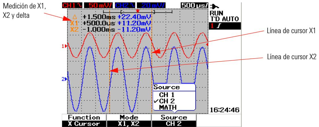
Figura 3-32 Medición del cursor X para la señal del canal 2 con líneas de cursor X1 y X2
