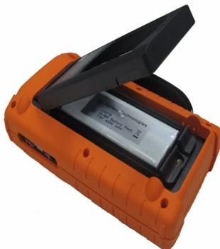
**Figura 8-5** Extraiga la cubierta de la batería sin retirar la base
