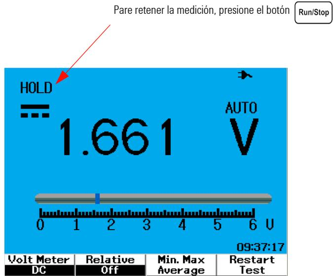
**Figura 4-2** Pantalla de la medición de CC
